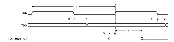
Figure 65. JTAG Test-Port Timing
