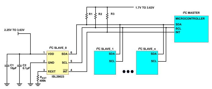
FIGURE 15. ISL29023 TYPICAL SYSTEM DIAGRAM
